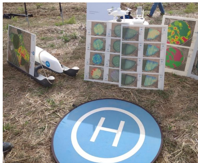
Figura 6 – Equipamentos para monitorização das pastagens, à esquerda o sensor de condutividade elétrica aparente e na parte superior, um drone.
